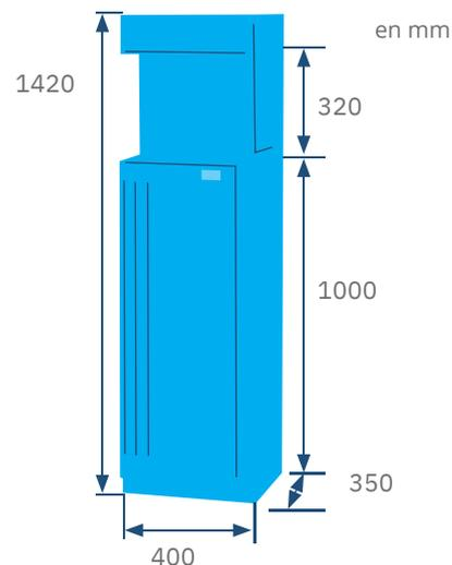
CARACTERISTIQUES GENERALES: Branchement sur le réseau d'eau de ville Nécessitant une évacuation
