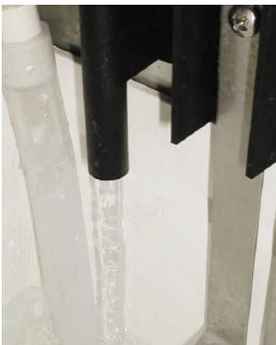
3. L'eau entre par l'électrovanne d'arrivée d'eau et remplit le réservoir jusqu'au niveau maximal contrôlé par une Sonde de niveau d'eau.
